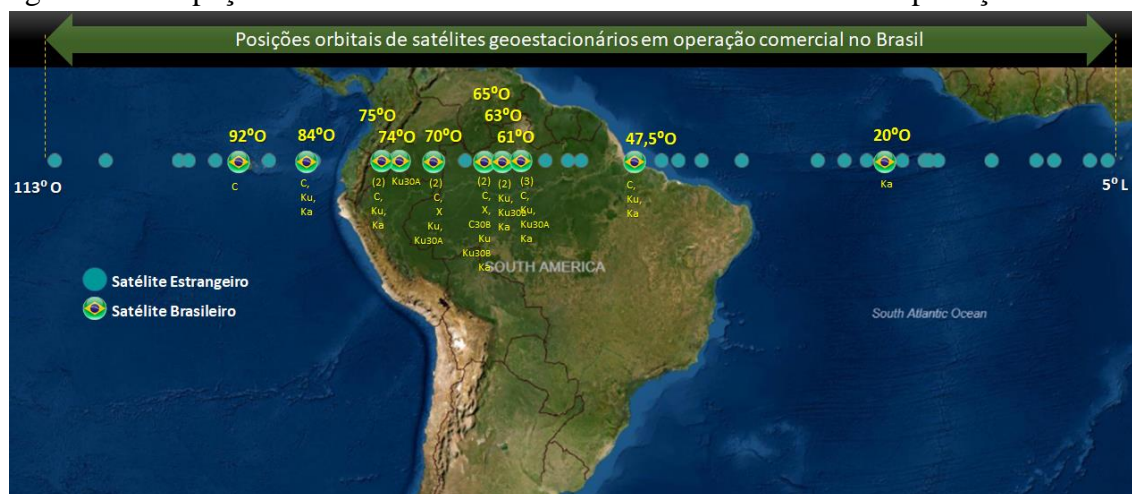
Figura 14: Ocupação Do Arco Orbital Por Satélites Com Direito De Exploração No Brasil
